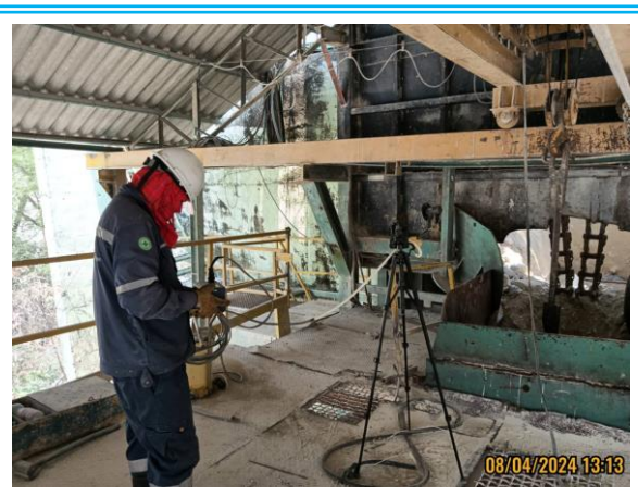
รูปที่ 4.3-8 แสดงการตรวจวัดค่าความทึบของฝุ่นละออง (Opacity) บริเวณจอร์จซ์เซอร์ วันที่ 8 เมษายน 2567
