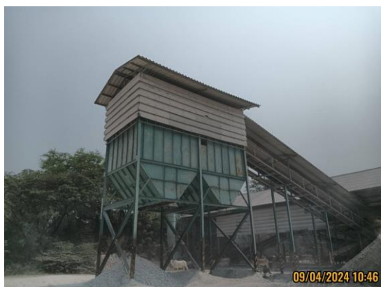
รูปที่ 3-17 สายพานลำเลียงแบบปิดคลุม
