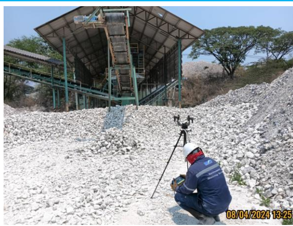
รูปที่ 4.3-11 แสดงการตรวจวัดค่าความทึบของฝุ่นละออง (Opacity) บริเวณจุดกองแร่ วันที่ 8 เมษายน 2567
