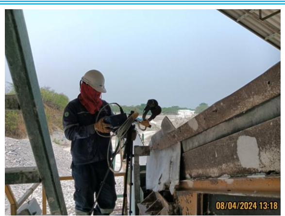
รูปที่ 4.3-10 แสดงการตรวจวัดค่าความทึบของฝุ่นละออง (Opacity) บริเวณตะแกรงคัดขนาด วันที่ 8 เมษายน 2567
